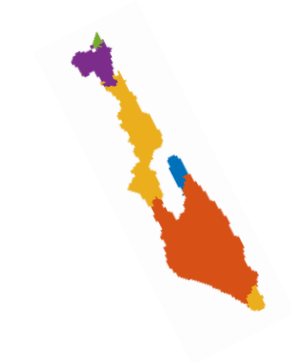
Figure 17 : Identification de zones hydrodynamiques d'après les volumes de mélange
